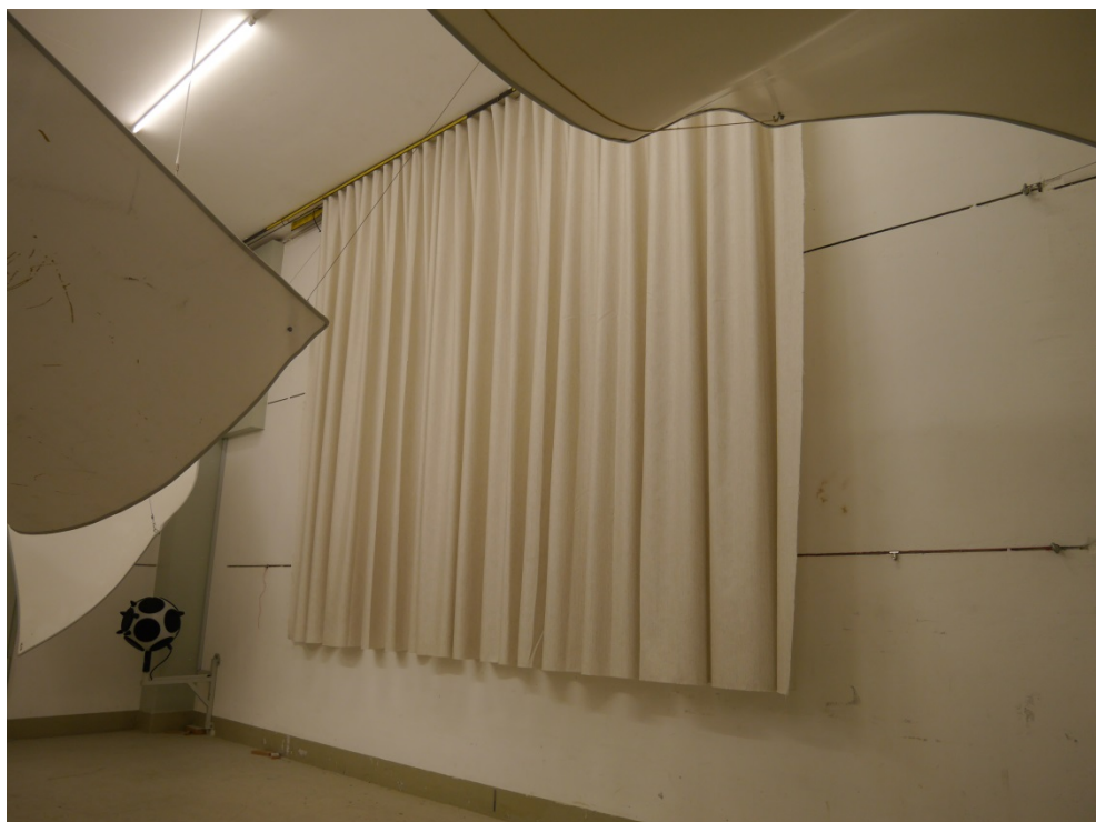
Abbildung C.2. Geraffte Prüfanordnung im Hallraum (Schrägensicht).
