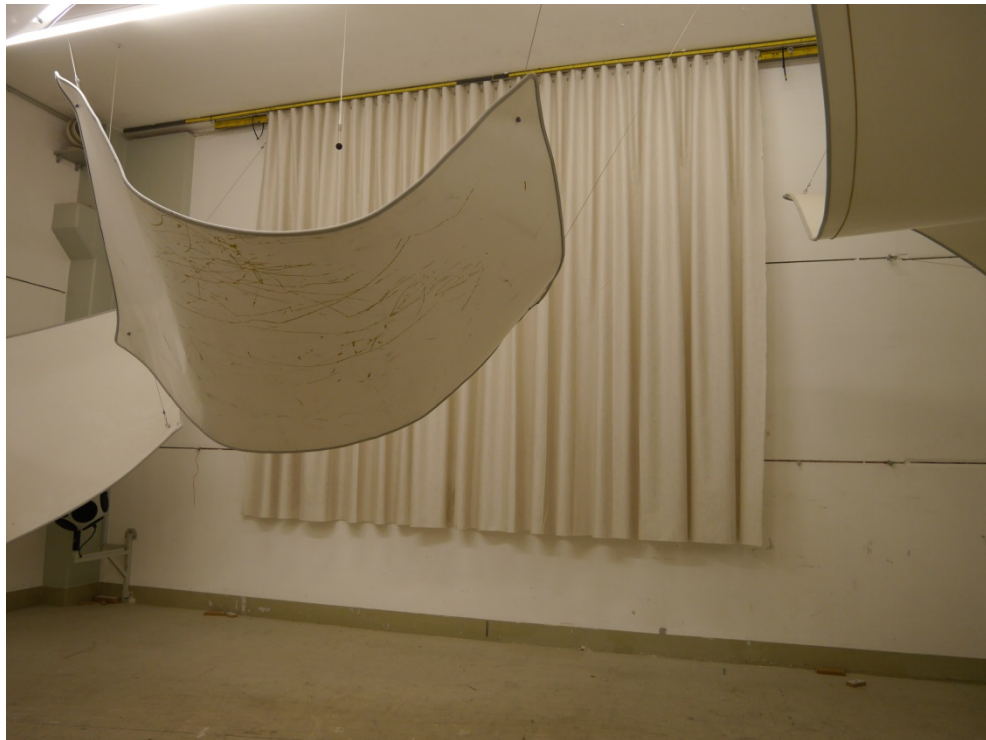
Abbildung C.1. Geraffte Prüfanordnung im Hallraum (frontale Ansicht).
